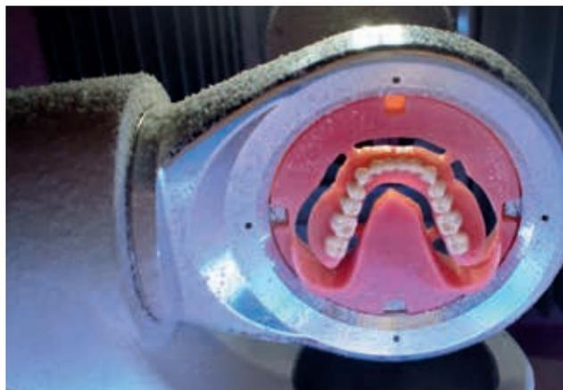
Die einzig manuelle Tätigkeit in diesem digitalen Prozess besteht nur noch darin, die Prothese nach Fertigstellung zu polieren und zu charakterisieren. Das **hyperDENT® Denture-Modul** ist eines der ersten Vollprothesen-CAM-Systeme, das automatisierte und speziell auf Prothesen ausgerichtete Werkzeugwegberechnungen verwendet, die in Kombination mit nahezu allen Fräsmaschinen funktionieren.
